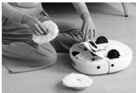
图 3-10 便携更换磁吸扫拖模块
