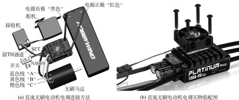
图 5.18 直流无刷电动机电调连接方法及实物照片
