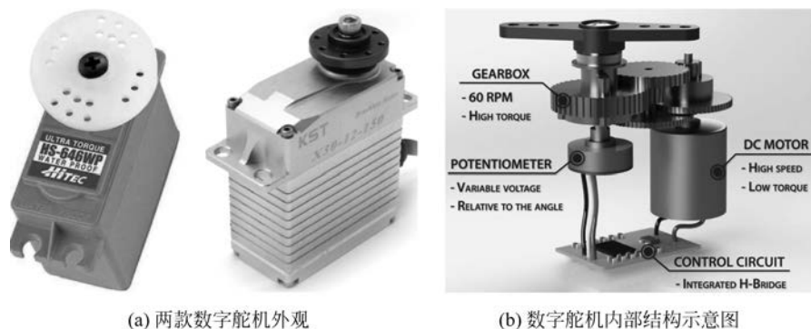
图 5.15 舵机的外观图和内部结构示意图
