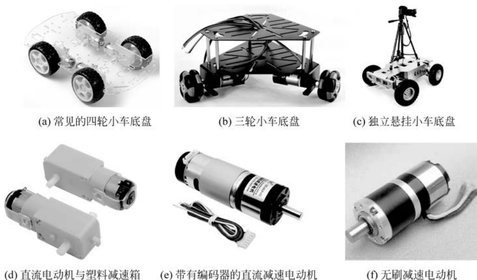
图 5.1 不同类型的轮式机器人底盘结构和减速电动机
