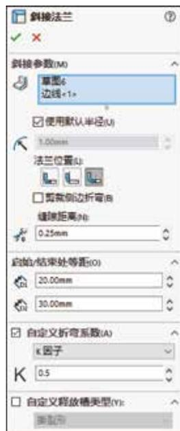
图 5.33 “斜接法兰”对话框
