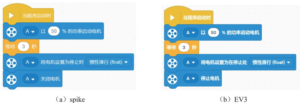
图 1.2.6 电机旋转指定时间的程序
