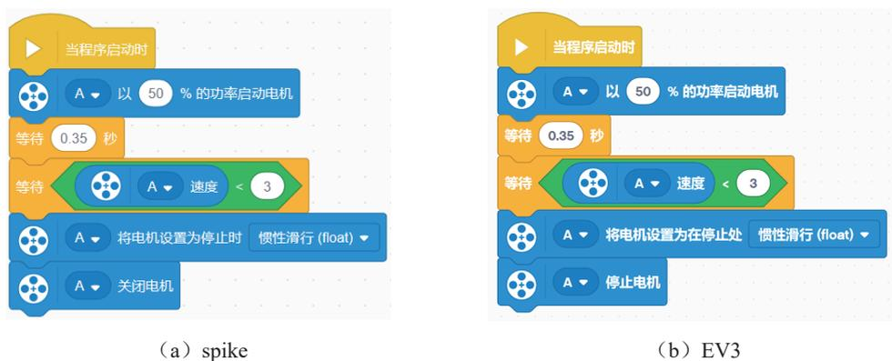
图 1.2.5 电机自动停转的程序
