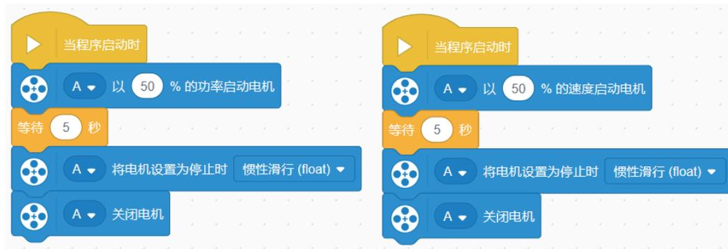
图 1.2.8 功率控制和速度控制的程序 (spike)
