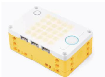
图 1.1.3 spike 机器人的主控制器
