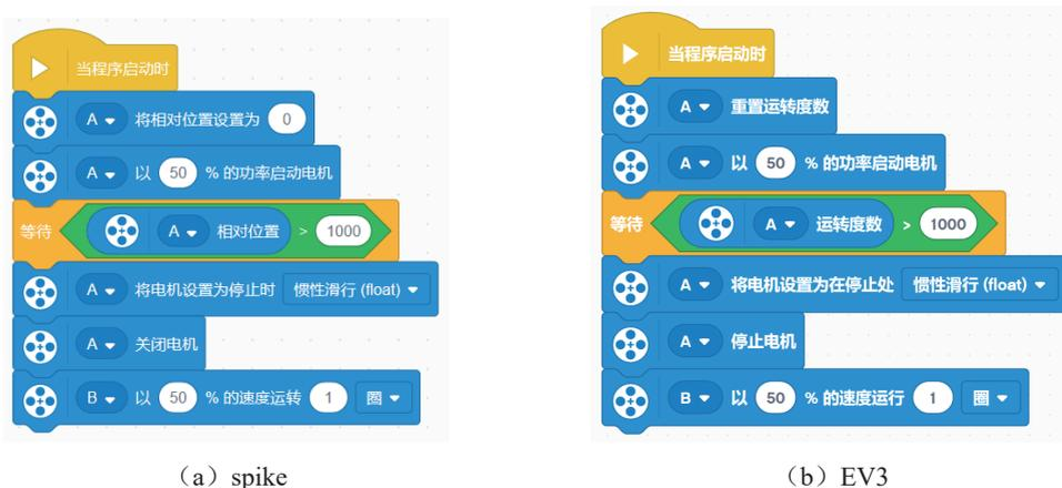
图 1.2.4 电机旋转测试程序
