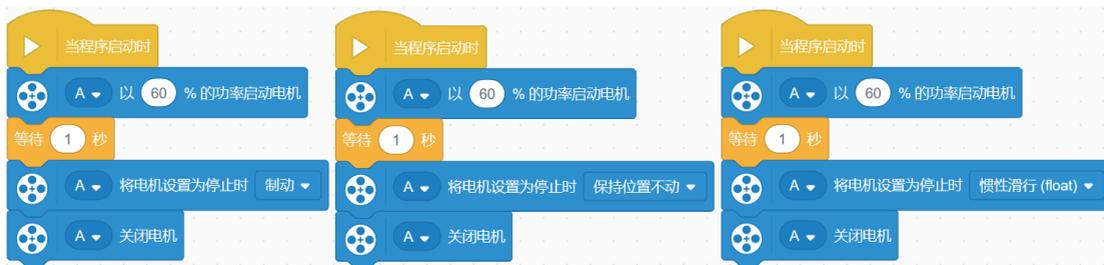
图 1.2.10 电机“制动”“保持位置不动”和“惯性滑行”的程序 (spike)
