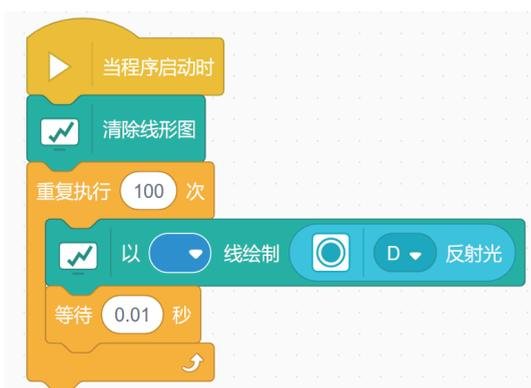
图 1.1.25 绘制线形图的程序
