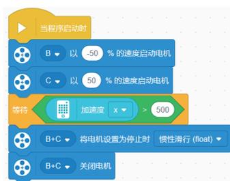
图 1.3.23 机器人撞击制动程序
