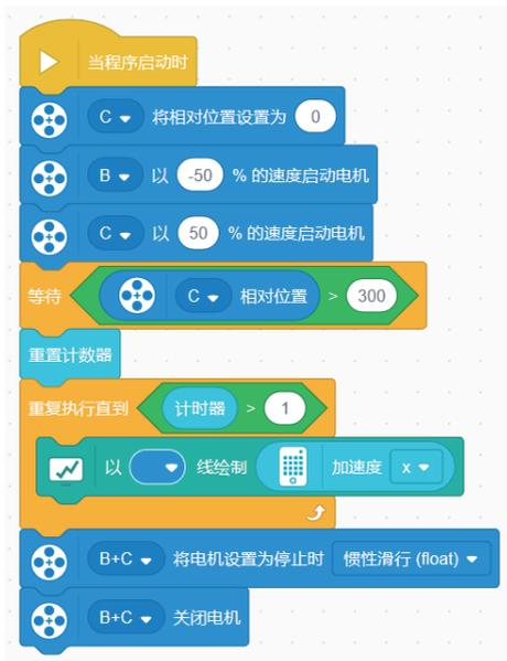
图 1.3.21 撞击加速度线形图程序
