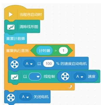
图 1.2.21 电机启动程序 (spike)
