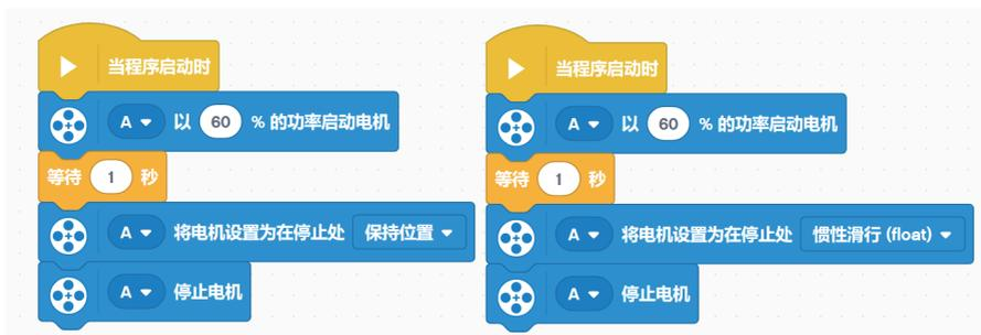
图 1.2.11 电机“保持位置不动”和“惯性滑行”的程序 (EV3)
