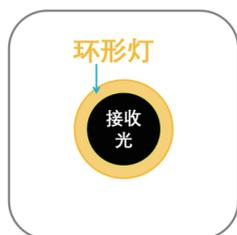
图 1.3.10 spike 的光电传感器
