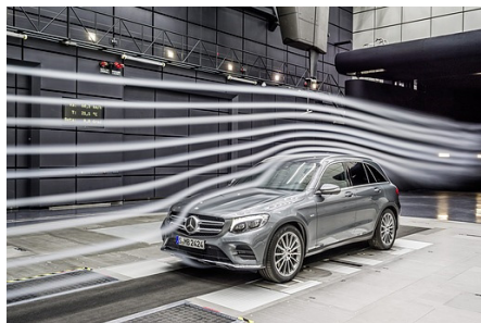
图1-48 奔驰汽车采用模拟与模型实验法2
