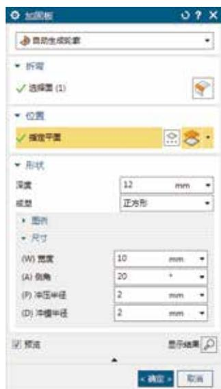
图 5.194 “加固板”对话框
