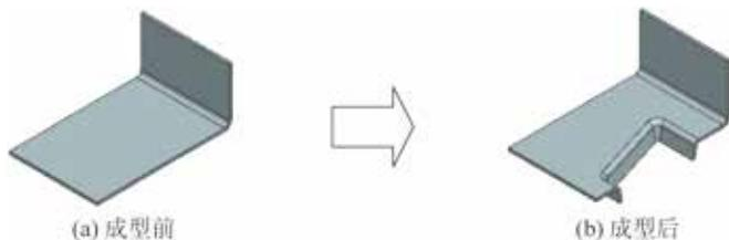
图 5.181 冲压开孔
