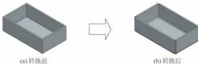
图 5.97 将实体零件转换为钣金
