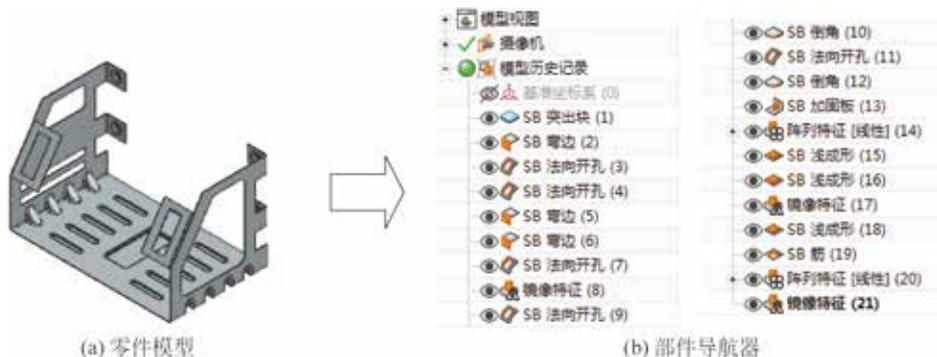
图 5.281 机床外罩模型及部件导航器
