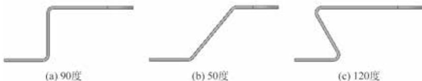
图 5.124 设置二次折弯角度
