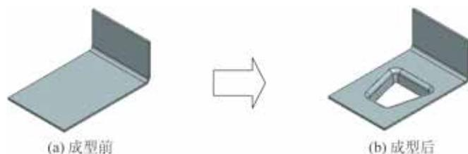
图 5.177 冲压开孔
