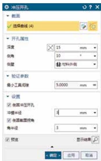
图 5.178 “冲压开孔”对话框
