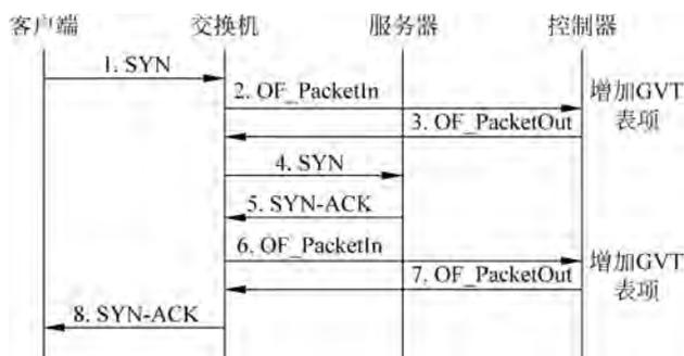
图 5.15 基于 TCP 连接的 GVT 生成过程
