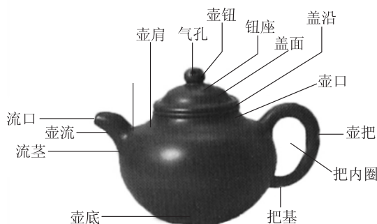
图 3-9 紫砂壶各部分名称示意图
