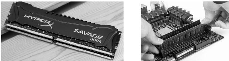
图 3-13 内存条及内存条的安装
