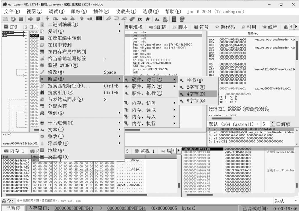
图 3-35 在程序中设置硬件访问断点
