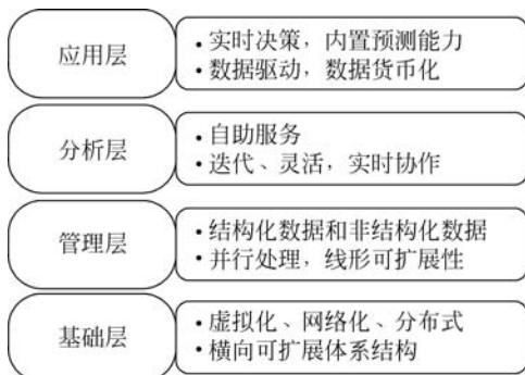
图 5-2 4 层堆栈式大数据技术架构
