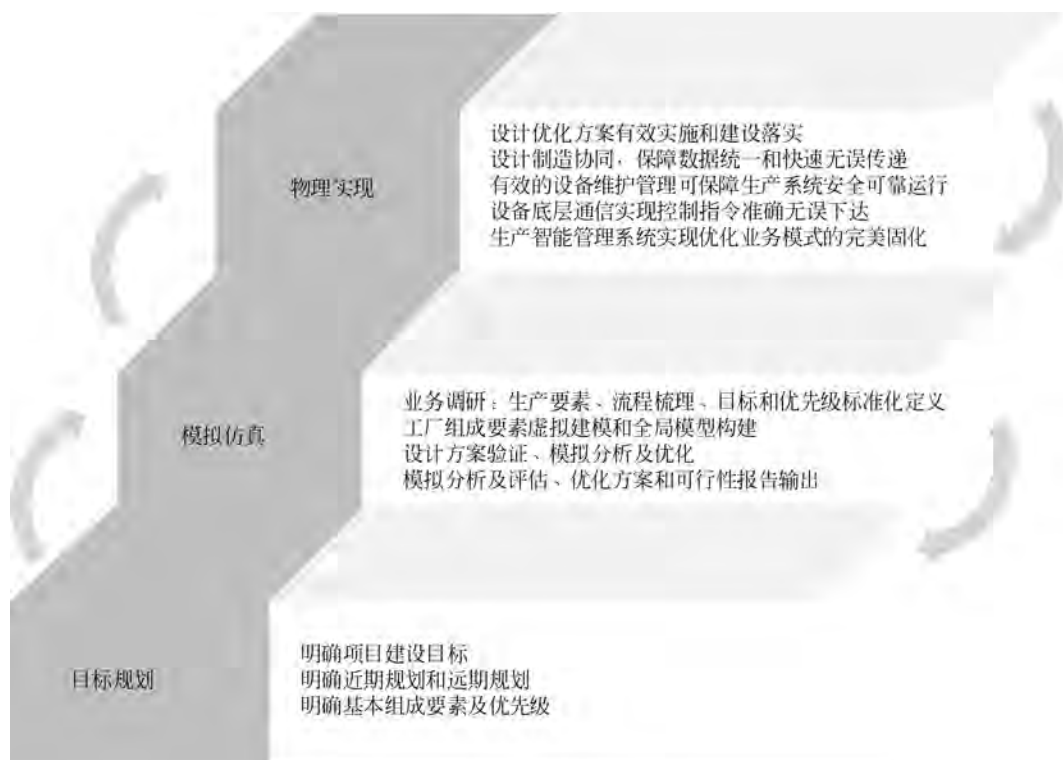
图 5.26 虚实结合的数字化工厂推进示意图
