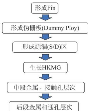
图 3.22 14nm 技术节点 FinFET 结构主要工艺流程示意图
