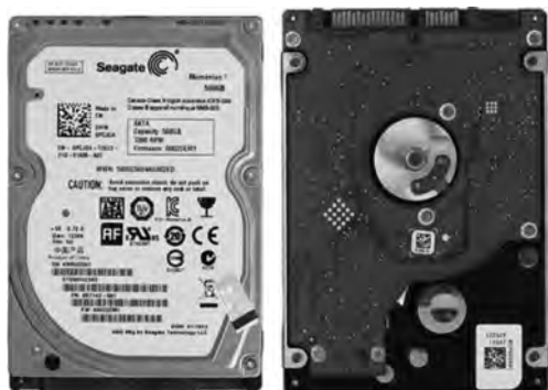
图 5-4 机械硬盘的外观结构
