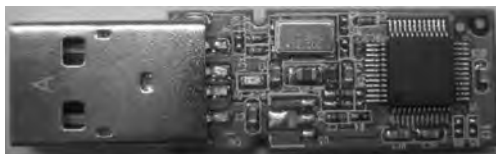
图 5-21 U 盘内部结构样式
