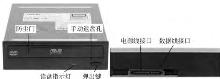
图 5-18 光驱的外观结构
