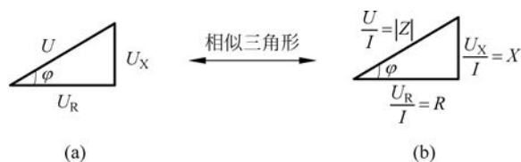
图 3-32 串联电路的电压三角形与阻抗三角形
