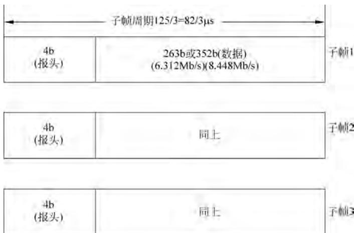
图 1-18 6.312Mb/s 和 8.448Mb/s 的 IDR 报头结构
