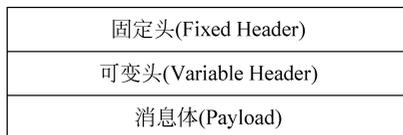
图 5-4 MQTT 数据包结构
