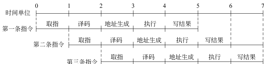
图 3.11 5 级流水的工作情形
