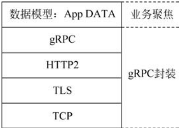
图 5-12 gRPC 协议栈分层示意图
