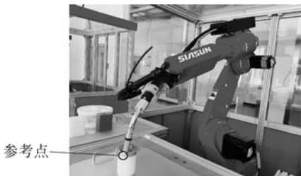
图 3-7 工具坐标系标定选择的任一参考点
