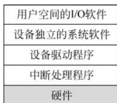
图 5.11 I/O 软件的层次结构
