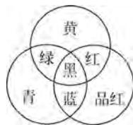
图 3-6 相减混色法的三基色示意图
