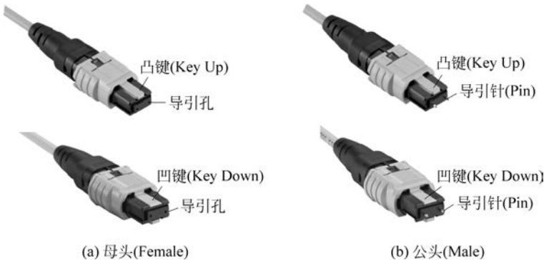
图 3-8 MPO 光纤连接器插头
