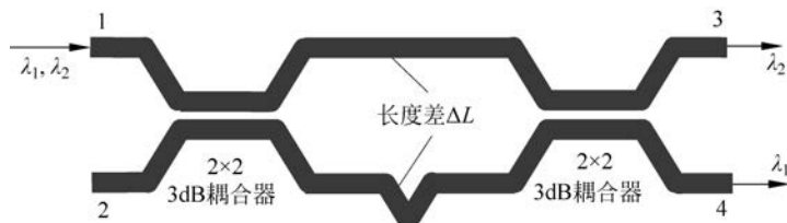
图 3-21 M-Z 滤波器结构原理图
