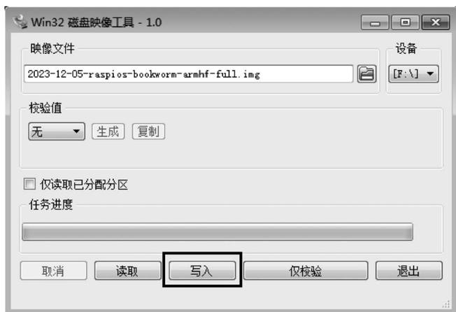
图 3-20 指定镜像文件后的 Win32 Disk Imager 工具窗口
