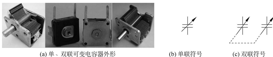
图 3-10 单、双联可变电容器外形及符号
