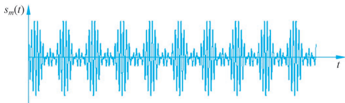
图 3-3 普通调幅“过调幅”波形
