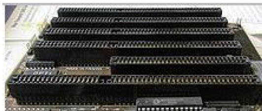
图 3.9 同时支持 8 位和 16 位 ISA 总线的主板
