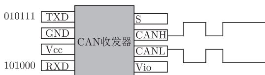
图 3.17 CAN 收发器芯片典型输入/输出信号
