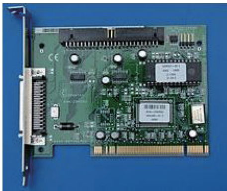
图 3.12 Adaptec 公司的 32 位 SCSI 适配器 PCI 卡
