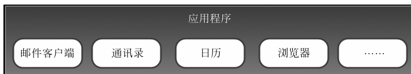
图 3-4 Android 系统应用程序层
