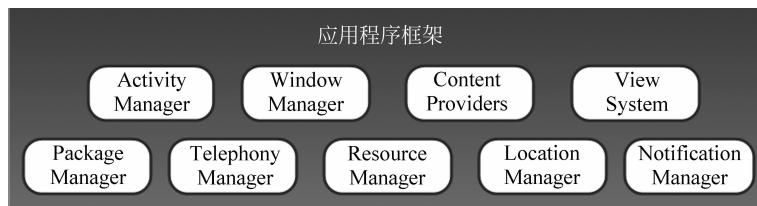
图 3-3 Android 系统应用程序框架层
