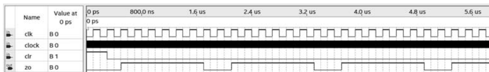
图 5-19 序列信号发生器工作时序
