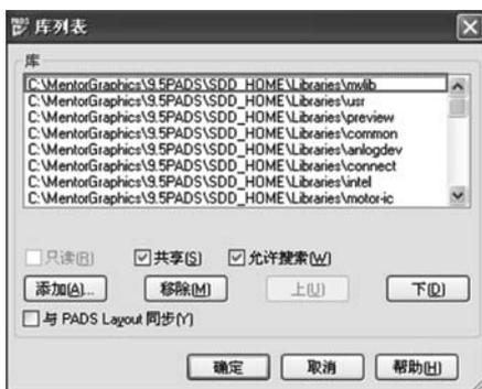
图 3.5 将 mylib 移至顶端
