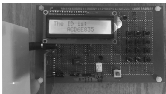
图 3-14 射频 13.56M 一卡通门禁系统白卡读卡界面
