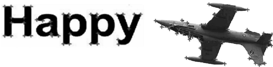
图 3.1.5 用最小核同值区算子检测到的角点
