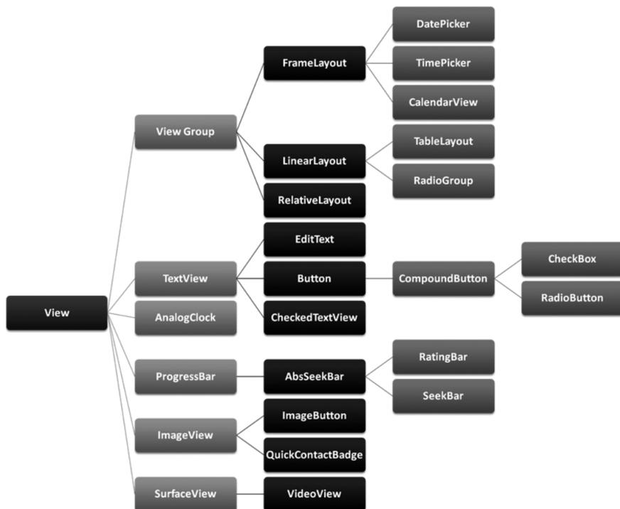
图 5.1 Android 控件继承结构
