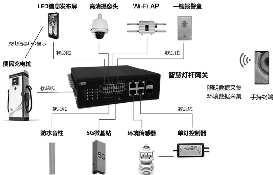
图 5-6 分布式软总线示例
