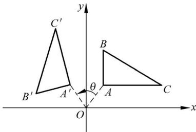
图 3-3 将  $\triangle ABC$  以坐标原点为基准点旋转  $\theta$  所得结果
