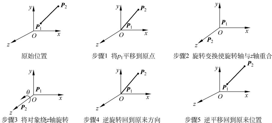
图 3-19 绕任意轴旋转时,将旋转轴变换成  $z$  轴的 5 个步骤
