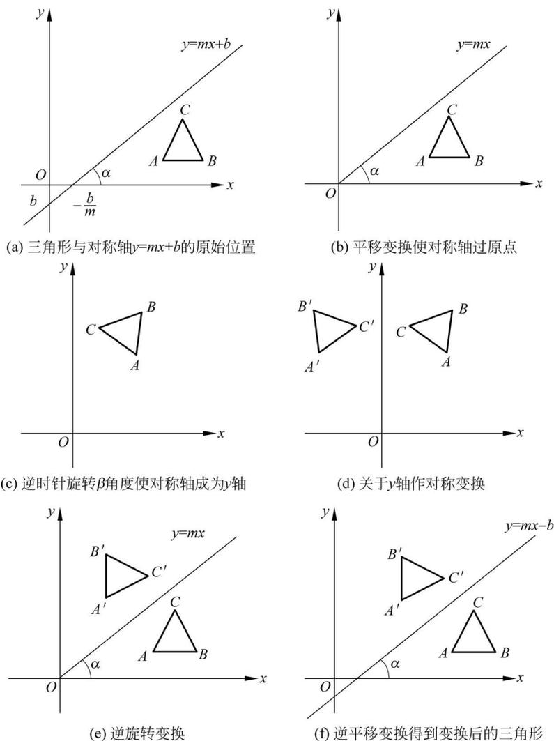
图 3-12 关于任意直线  $y = mx + b$  的对称变换过程
