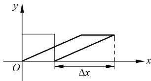
图 3-13 简单的沿  $x$  方向的错切变换
