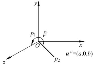
图 3-21 求旋转变换  $\mathbf{R}_y(\beta)$  的参数
