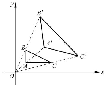
图 3-4 以固定点为坐标原点的缩放变换示意图
