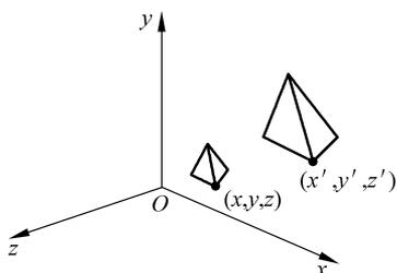
图 3-22 相对于坐标原点的缩放变换
