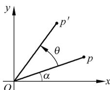
图 3-2 相对原点将点  $p$  旋转得到  $p'$
