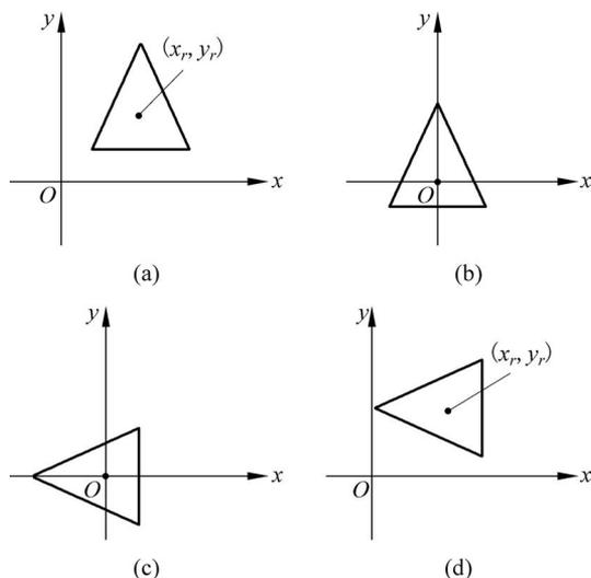
图 3-5 基准点为 $(x_r, y_r)$ 的旋转变换
