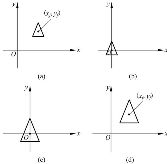
图 3-6 固定点为 $(x_f, y_f)$ 的缩放变换
