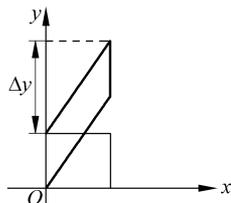
图 3-14 简单的沿  $y$  方向的错切变换
