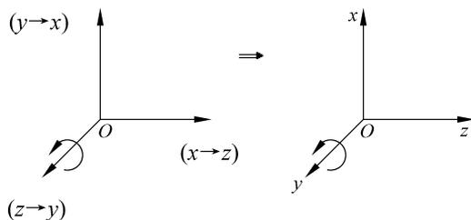
图 3-17 由绕  $z$  轴旋转经过循环坐标替换生成绕  $y$  轴旋转
