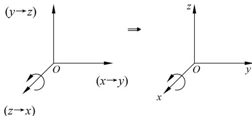
图 3-18 由绕  $z$  轴旋转经过循环坐标替换生成绕  $x$  轴旋转
