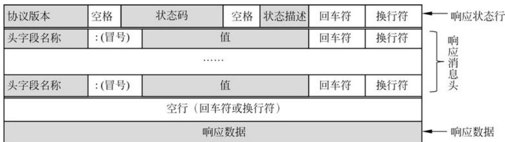
图 3-11 HTTP 响应消息结构
