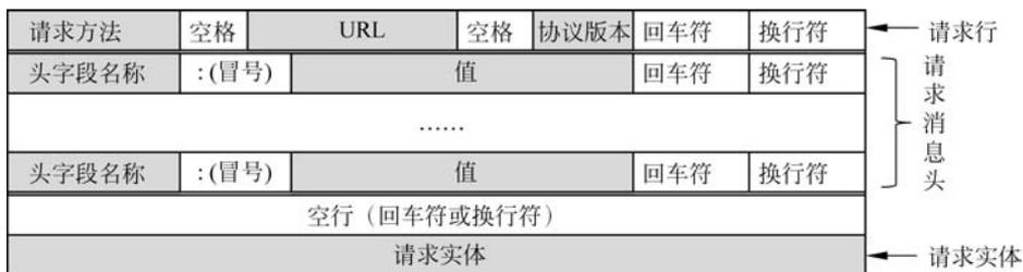
图 3-10 HTTP 请求消息结构
