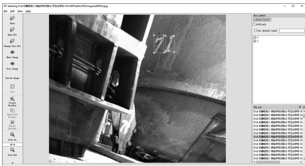
图 3-6 使用 LabelImg 工具标注钢包包号
