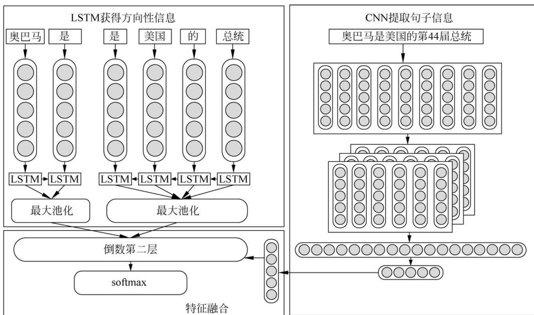
图 3-6 基于 LSTM 的远程监督实体关系抽取框架
