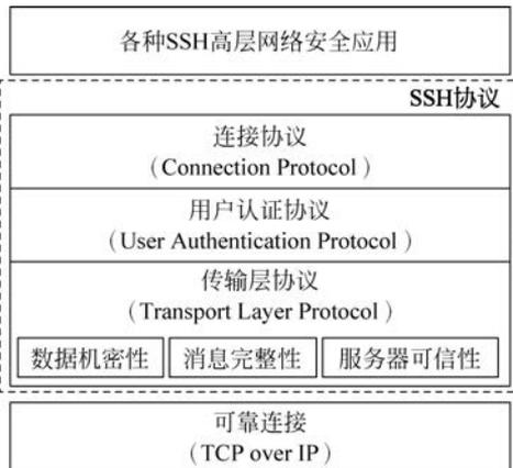
图 3-3 SSH 协议的体系结构
