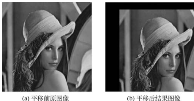
图 3.10 例 3.6 的整幅图像平移截断移出部分结果
