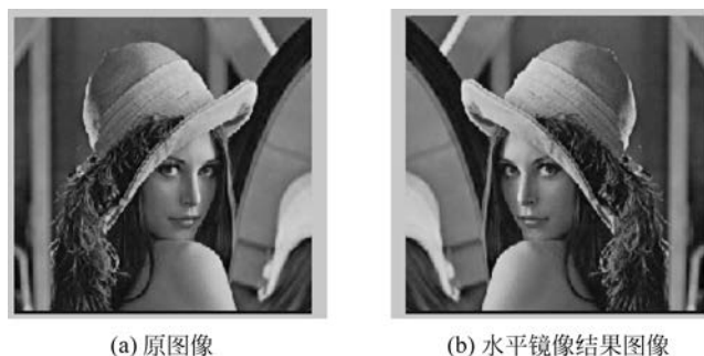
图 3.16 图像水平镜像结果示例
