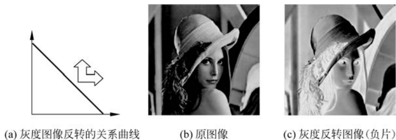
图 3.1 灰度图像反转原理及图例
