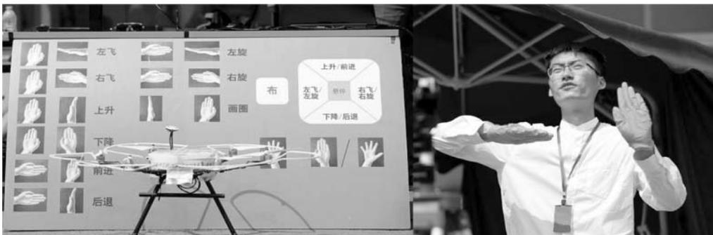
图 5.41 中国科学院沈阳自动化所人机协作的智能无人机系统
