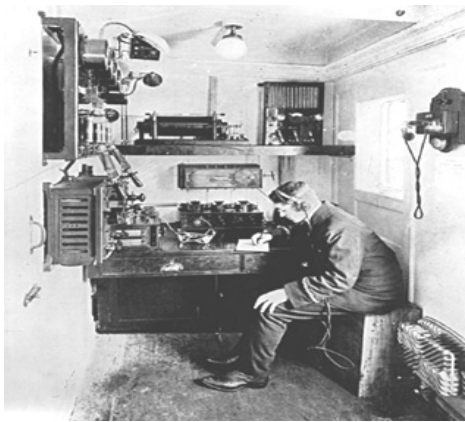
图 1.5 1912 年,航船上使用的无线电报装置
