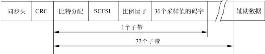
图 3-24 MPEG-1 层 II 的音频码流的数据帧格式
