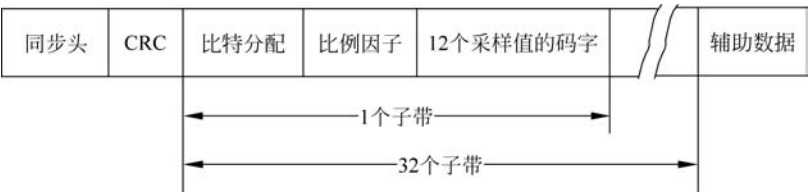
图 3-22 MPEG-1 层 I 的音频码流的数据帧格式
