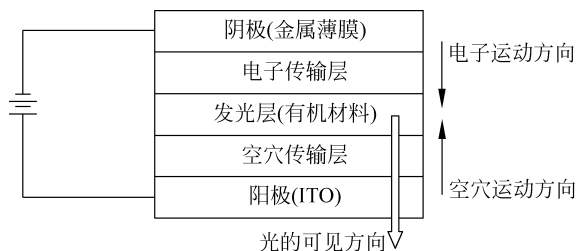
图 5-9 一个典型的 OLED 结构
