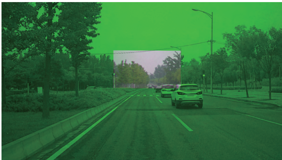
图 3-19 良好的长焦摄像头与短焦摄像头标定结果
