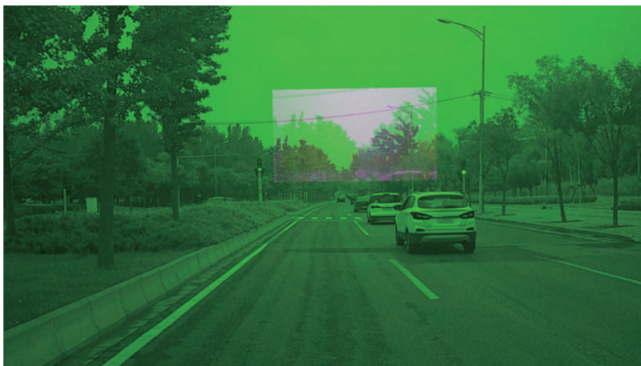
图 3-20 错误的长焦摄像头与短焦摄像头的标定结果
