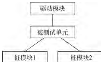
图 5-5 单元测试中 驱动程序和桩程序
