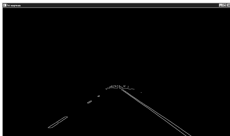
图 5.16 在感兴趣区域提取轮廓图中的直线
