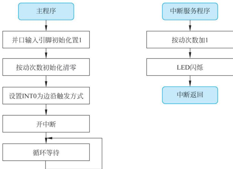
图 3-24 程序 p3\_4\_2.asm 的流程图
