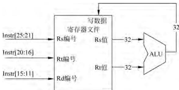
图 3-3 R 型指令执行部件结构
