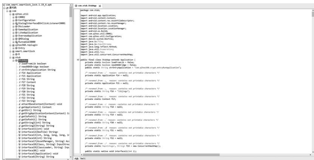
图 3.4 加固后的 Dex 文件被反编译后的结果
